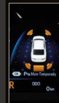
▲ สัญญาณเตือนกระแสด้านท้าย และที่มุมกันชน ทั้ง 4 มุม
